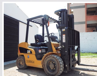
MONTACARGAS Capacidad de carga de 3 toneladas.
