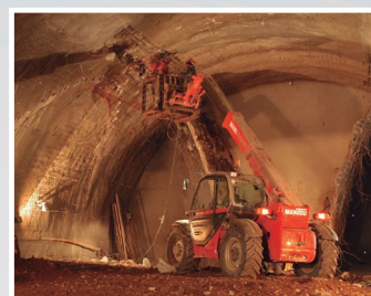
MANIPULADOR TELESCÓPICO Altura de levante máxima 9,9 m. Capacidad de carga de 3 toneladas.
